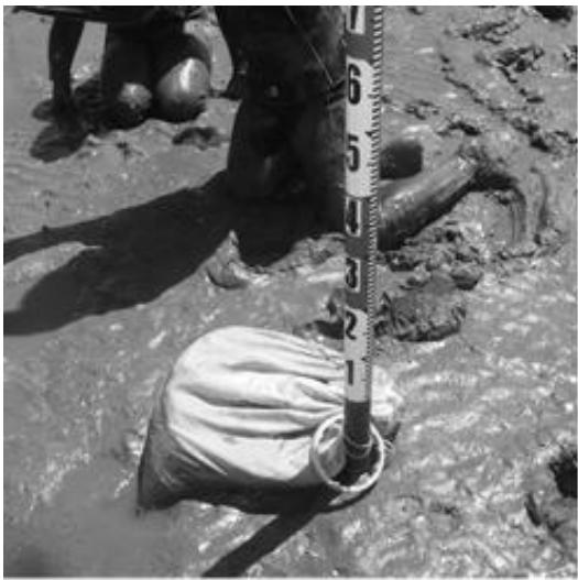
写真-2 干潟上へのフルボ酸鉄シリカ資材の設置状況
