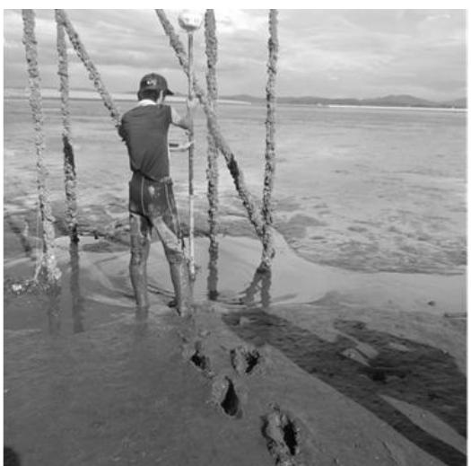
写真-3 RTK測量機器を用いた干潟標高の測量
